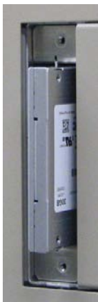
縦置きの場合は、SSD のラベルが右に、横置きの場合は下になります。
