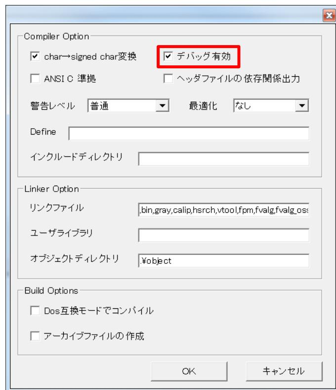
デバッグビルドを実行後、アプリケーションを FV2340-LNX に転送します。
