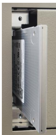
縦置きの場合は、SSD のラベルが左に、横置きの場合は上になります。
